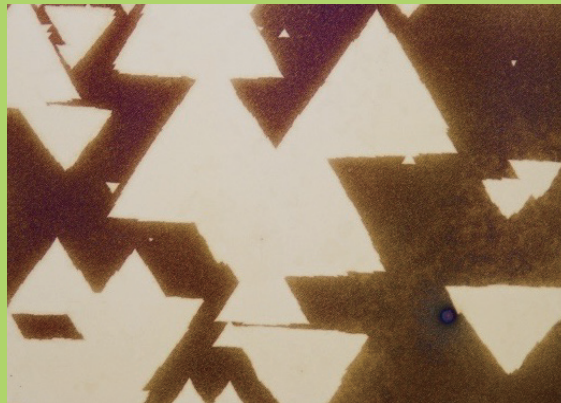
Cu(111) 薄膜上に成長した単層 hBN の配向グレイン (左) とそのモデル図 (右)
